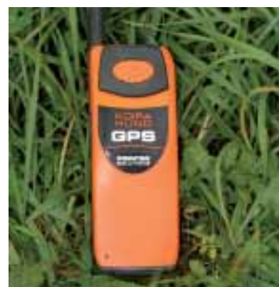
Die GPS-TrackBox ist mit einer eigenen SIM-Karte ausgestattet und wird mit einem Trageschirr am Hund befestigt. Das Gerät ermittelt auf SMS-Anfrage seine Position und sendet die Daten automatisch an das GPS-Handy des Jägers zurück.
